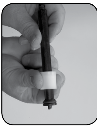
Paso 4a para (TD100 - 1% & TD200 - 0.5%) Reemplace el PISTÓN DOSIFICADOR #44 con el extremo acampanado hacia arriba y el O-ring #14.
