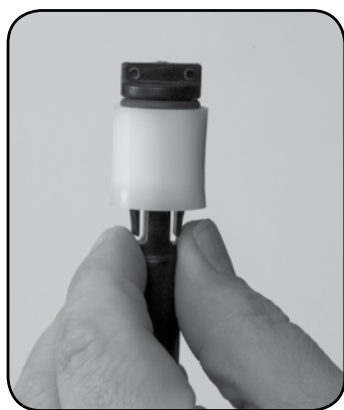
Etape 4 pour (1% & 0.5%) Appuyez sur les languettes et retirez le piston doseur.
